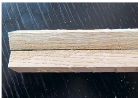
Seitliche Verklebung von Stäbchen aus Versiegelung.
