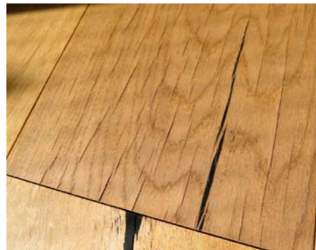
/ Mikro- und Trockenrisse verschließen sich meist im Sommer wieder und sind oft gar nicht mehr sichtbar.
